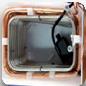
Sistema refrigeración banco de hielo.
